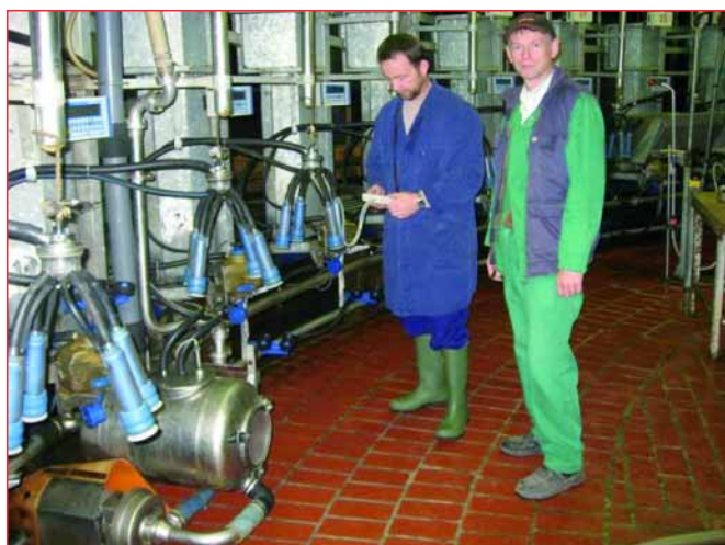
Herr Seidenstücker mit dem Betriebstechniker der Milchland GmbH Veilsdorf, Herrn Morgenrot, während der Prüfung der Pulsation
