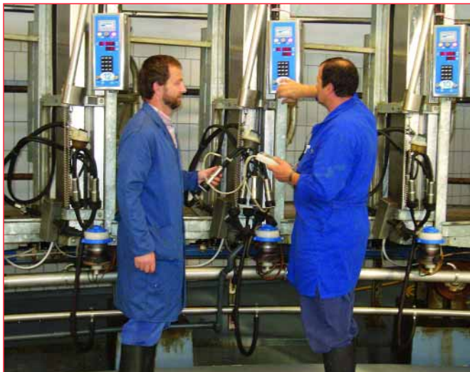
Milchqualitätsberater Herr Manske und Herr Seidenstücker prüfen das Melkkarussell in der MVA Rockendorf nach technischen Vorgaben der DIN/ISO 5707/6690 („Melkanlagen TÜV“).
