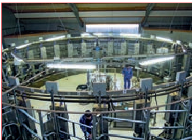
Erstes Melkkarussell in Thüringen (Impulsa) in der MVA Rüdersdorf, welches mit Multilactor ausgerüstet ist.
