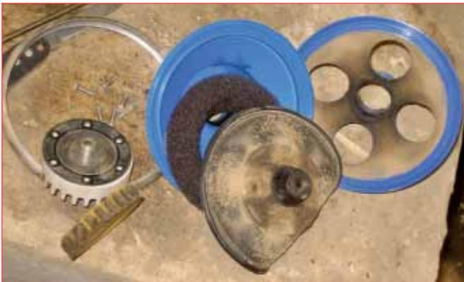
Innenansicht eines verschmutzten Regelventils
