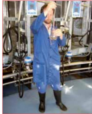
Herr Seidenstücker bei der Überprüfung der Konzentration des Desinfektionsmittels
